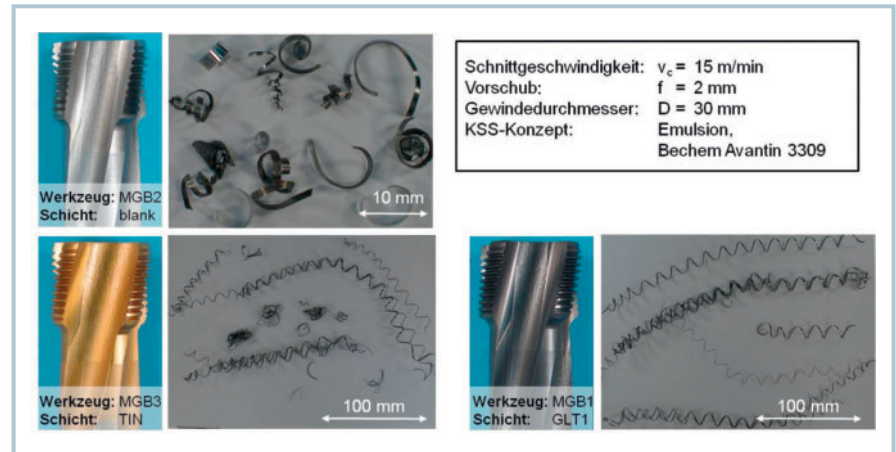
2 Abhängig von der Werkzeugbeschichtung tritt beim Gewindeschneiden eine ungünstige Spanform auf
